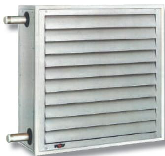
Тепловентилятор во взрывозащитном исполнении для взрывоопасной зоны 2 (II 3G с IIB T4 X); с выпускными жалюзи для монтажа на стене или потолке, для обогрева или охлаждения в режимах смешения, рециркуляции, подачи наружного воздуха и фильтрации.
