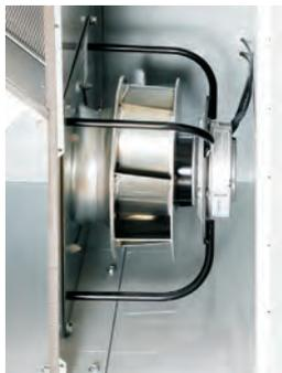
Высокоэффективные вентиляторы свободного хода с односторонним всасыванием подсоединены непосредственно к бесконтактному электродвигателю постоянного тока с электронным коммутатором с низким потреблением энергии, регулируются бесступенчато (от 0 до 10 В).
