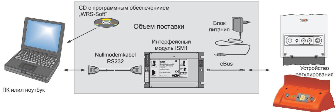
Система аппаратного и программного обеспечения для управления при удаленном подключении через модем
