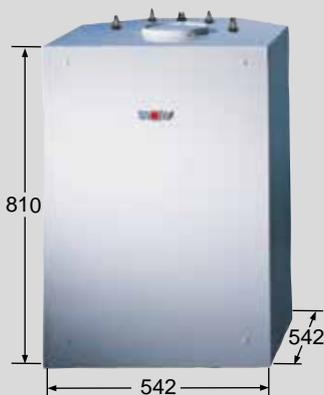
Подключения R $\frac{3}{4}$ " для подающей и обратной линии, холодной воды, горячей воды и циркуляции, расположены сверху на водонагревателе для упрощения монтажа, отверстие для очистки также на верхней стороне водонагревателя
