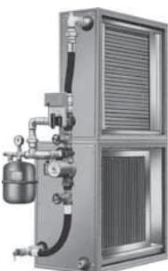
Теплый вытяжной воздух нагревает воду в теплообменнике вытяжного воздуха. Циркуляционный насос подает нагретую воду к теплообменнику наружного воздуха, который передает тепло потоку наружного воздуха.
