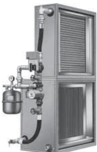
Теплый вытяжной воздух нагревает воду в теплообменнике вытяжного воздуха. Циркуляционный насос подает нагретую воду к теплообменнику наружного воздуха, который передает тепло потоку наружного воздуха.
